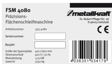
Obr. 4: Typový štítek a označení CE brusky FSM 4080
