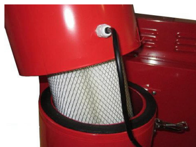
Obr. 6: Filtr pískovacího boxu SSK 2.5
