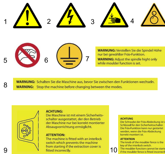
Obr. 1: Výstražné štítky - 1 Obecné nebezpečí | 2 Varování před nebezpečným elektrickým napětím | 3 Nebezpečí skřípnutí horních koncetin | 4 Varování před otáčejícími se díly, nebezpečí skřípnutí | 5 Nebezpečná oblast | 6 Uzemnění | 7, 8, 9, 10 Bezpečnostní pokyny
