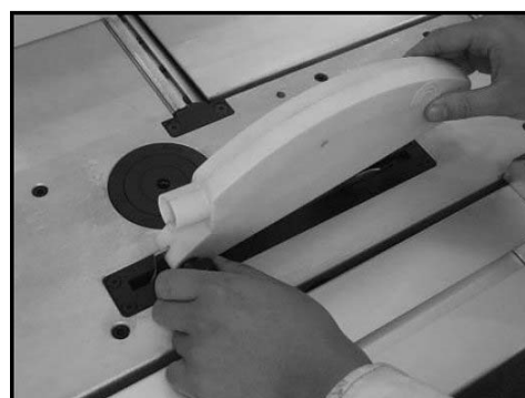
Obr. 18: Montáž ochranného krytu pilového kotouče
