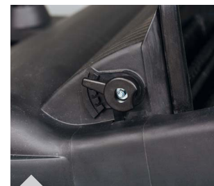
Jednoduché nastavení výšky zametačích válců
