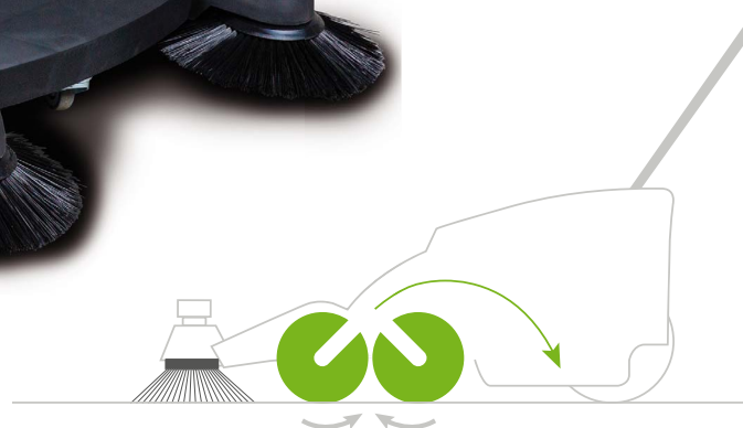
Systém dvou protiběžných kartáčových válců
