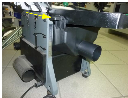
Obr. 8: Montáž odsávacího krytu
