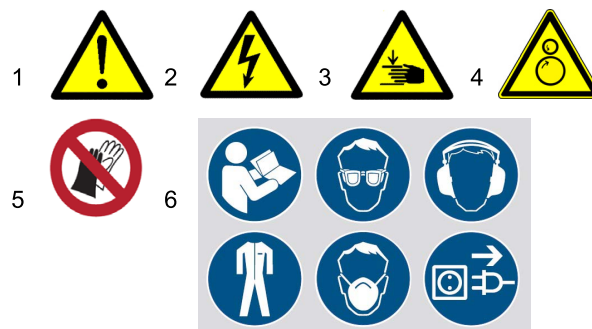
Obr. 1: Výstražné štítky - 1 Varování před nebezpečím | 2 Varování před nebezpečným elektrickým napětím | 3 Nebezpečí skřípnutí horních končetin | 4 Varování před otáčejícími se díly | 5 Nepoužívejte ochranné rukavice | 6 Bezpečnostní pokyny
