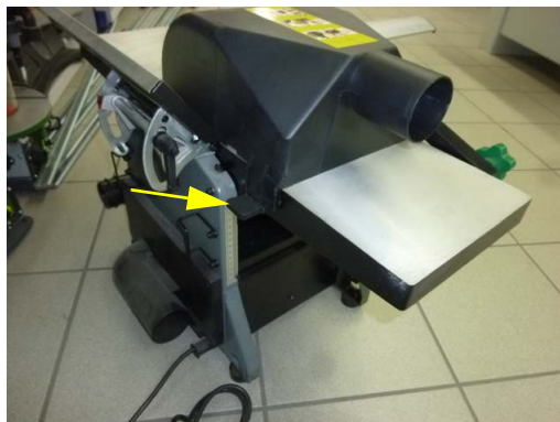
Obr. 12: Montáž odsávacího krytu
