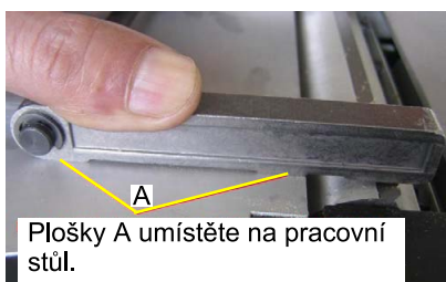
Obr. 16: Nastavení hoblovacího nože na plošku B
