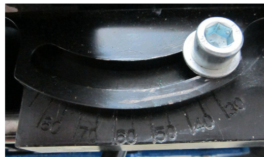
Abb. 10: Nastavení brusného úhlu
