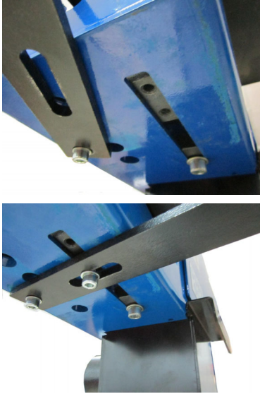
Obr. 11: Nastavení pracovní plochy na zadní straně stroje
