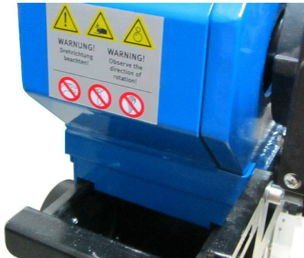
Obr. 7: Zavřený kryt na zadní straně brusky
