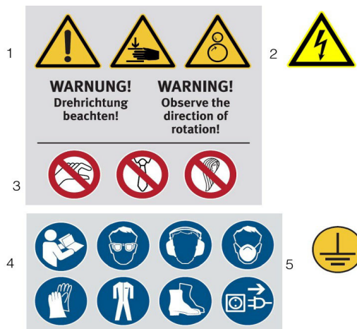
Obr. 1: Výstražné štítky - 1 Nebezpečí poranění rukou | 2 Nebezpečně elektrické napětí | 3 Zákazy | 4 Pokyny pro osobní bezpečnost | 5 Symbol pro uzemnění
