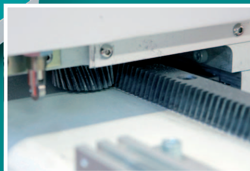
Hřeben s šikmým ozubením a pastorek
