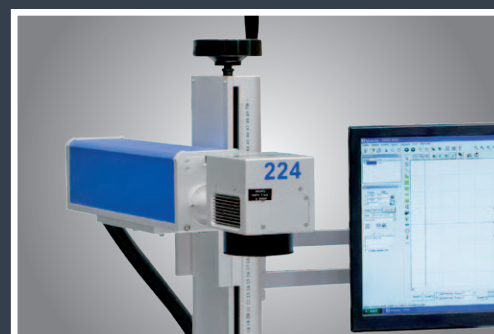
Nastavení ohniskové vzdálenosti ručním kolečkem na sloupu s milimetrovou stupnicí
