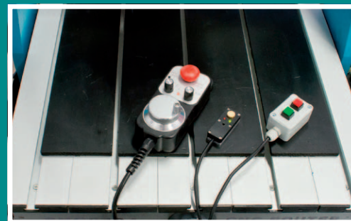
MPG ovladač, sonda pro délkovou korekci nástroje a tlačítko START/STOP
