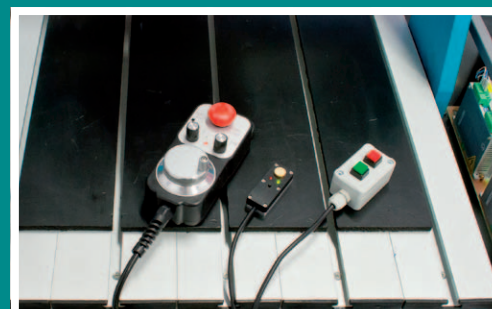
MPG ovladač, sonda pro délkovou korekci nástroje a tlačítko přerušení/start programu
