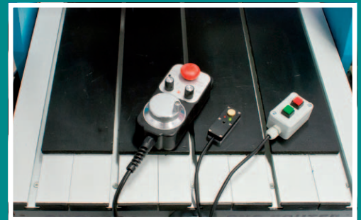
MPG ovladač, nástrojová sonda a tlačítko START/STOP
