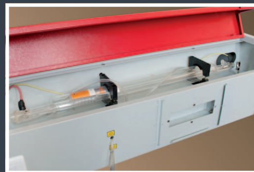
Vodou chlazená laserová trubice S 4040
