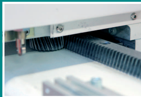
Hřeben s šikmým ozubením a pastorek
