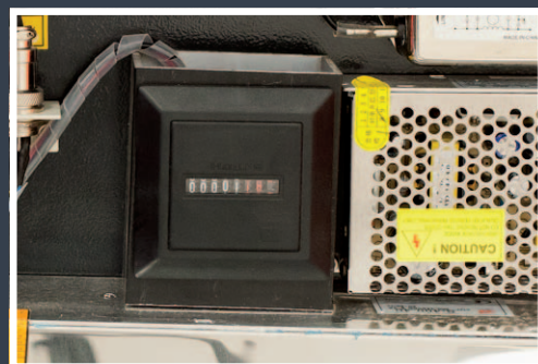
Počítadlo provozních hodin
