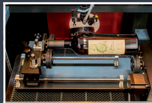
Gravírování rotačních ploch
