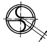
Querschneidenlänge 10 % vom Bohrer – \phi
