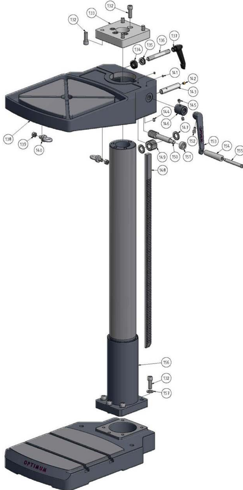
Obr. 7-8: Sloup a pracovní stůl
