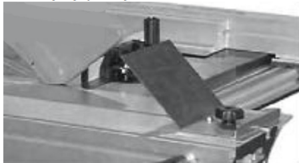
Obr. 3: Ochranný kryt proti vymrštění obrobku
