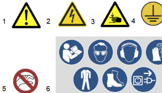
Obr. 1: Výstražné štítky - 1 Varování před nebezpečím | 2 Varování před nebezpečným elektrickým napětím | 3 Nebezpečí skřípnutí horních končetin | 4 Uzemnění | 5 Nedotýkejte se! | 6 Bezpečnostní pokyny
