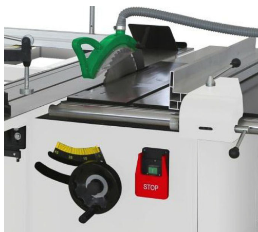
Obr. 22: Ruční kolo pro nastavení výšky pilového kotouče
