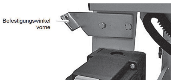
Obr. 12: Montáž zpevňovacích úhelníků
