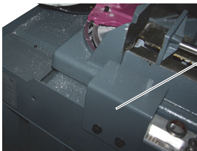
Obr. 3-2: Montáž opěrky materiálu
