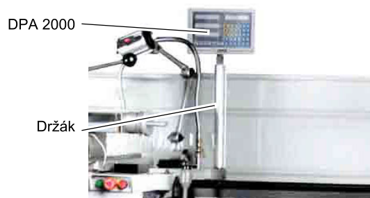
Obr. 3-4: Montáž digitálního odměřování DPA 2000
