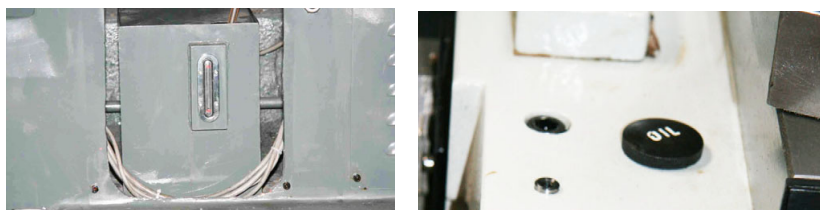
Obr. 3-6: Nádrž centrální jednotky mazání - Plnicí otvor suportové skříně
